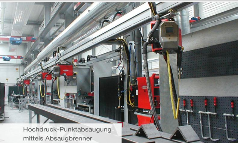
Hochdruck-Punktabsaugung mittels Absaugbrenner
