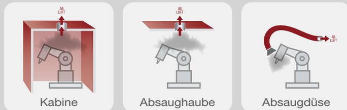
*Roboterinhausungen garantieren bestmögliche Erfassung des Schweißrauches. Ein effektiver Lärm und Blendschutz!*
