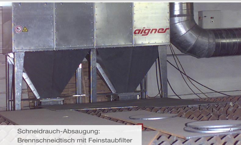
Schneidrauch-Absaugung: Brennschneidertisch mit Feinstaubfilter
